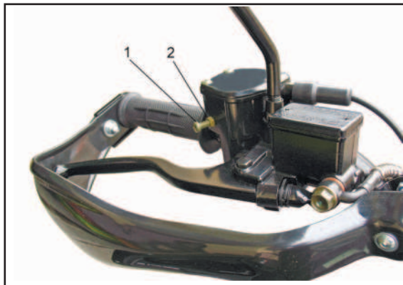
1. Регулировочный винт. 2. Контргайка.
