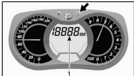
1. Режим максимальной скорости (TOP_SPD)
