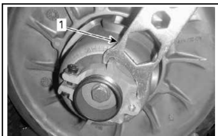
АЛЮМИНИЕВАЯ РЕГУЛИРОВОЧНАЯ МУФТА
