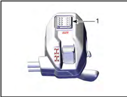
1. Переключатель эксплуатационных режимов двигателя
