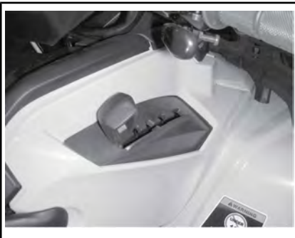
РАСПОЛОЖЕНИЕ РЫЧАГА ПЕРЕКЛЮЧЕНИЯ ПЕРЕДАЧ
