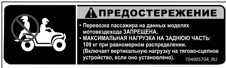
НАКЛЕЙКА 6 — Outlander X mr (570): ЗАДНЕЕ КРЫЛО (ДЛЯ ОЗНАКОМЛЕНИЯ СО ЗНАЧЕНИЯМИ СМ. РАЗДЕЛ ТЕХНИЧЕСКИХ ХАРАКТЕРИСТИК)
