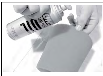
ТИПОВОЙ ВАРИАНТ – НАНЕСЕНИЕ МАСЛА НА ПОРОЛОНОВЫЙ ФИЛЬТР
