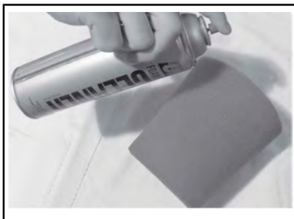
ТИПОВОЙ ВАРИАНТ – НАНЕСЕНИЕ МАСЛА НА ПОРОЛОНОВЫЙ ФИЛЬТР
