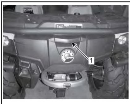
1. Защёлка крышки заднего багажного отделения
