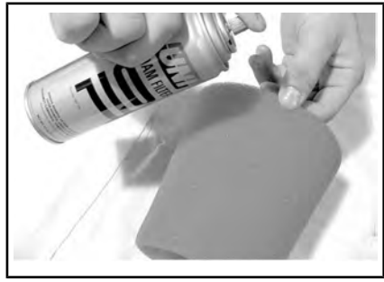
ТИПОВОЙ ВАРИАНТ - НАНЕСЕНИЕ МАСЛА НА ПОРОЛОНОВЫЙ ФИЛЬТРУЮЩИЙ ЭЛЕМЕНТ
