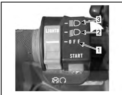
ФУНКЦИИ ПЕРЕКЛЮЧАТЕЛЯ СВЕТА ФАР
