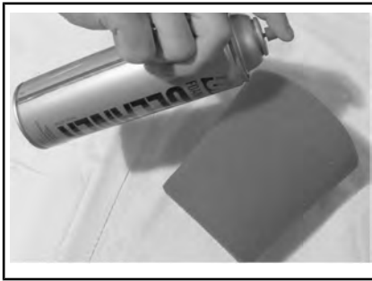
ТИПОВОЙ ВАРИАНТ – НАНЕСЕНИЕ МАСЛА НА ПОРОЛОНОВЫЙ ФИЛЬТР
