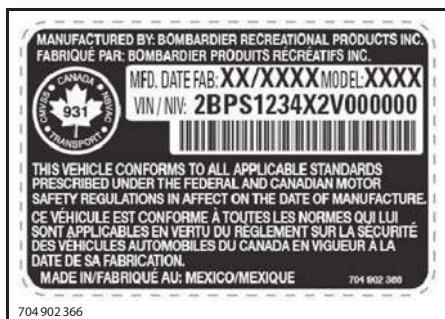
ТИПОВОЙ ВАРИАНТ - ТАБЛИЧКА С СЕРИЙНЫМ НОМЕРОМ ТРАНСПОРТНОГО СРЕДСТВА ПОД ПЕРЧАТОЧНЫМ ЯЩИКОМ
