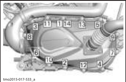
ПОРЯДОК ЗАТЯЖКИ ВИНТОВ КРЫШКИ ВАРИАТОРА -МОДЕЛЬ БЕЗ НАДДУВА
