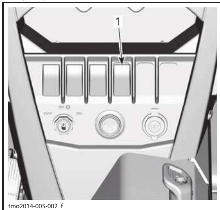
1. Переключатель режимов работы усилителя рулевого управления (DPS)
