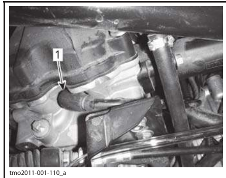
ВИД СПРАВА – ЗАДНИЙ ЦИЛИНДР 1. Свеча зажигания
