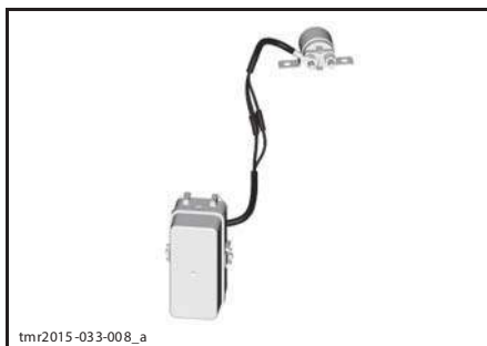
ПЛАВКАЯ ВСТАВКА ПОДСОЕДИНЕННАЯ К БЛОКУ ПРЕДОХРАНИТЕЛЕЙ
