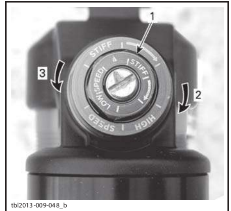
РЕГУЛИРОВКА ДЕМПФИРОВАНИЯ БЫСТРОГО СЖАТИЯ (ВОСПОЛЬЗУЙТЕСЬ КЛЮЧОМ 17 ММ)
