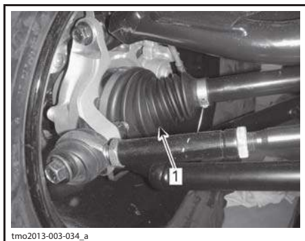
Задняя часть мотовездехода 1. Внешний пыльник приводного вала
