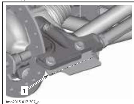
1. Предел износа удлинителя скребка
