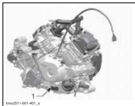
ТИПОВОЙ ВАРИАНТ - ТАБЛИЧКА С СЕРИЙНЫМ НОМЕРОМ ДВИГАТЕЛЯ
