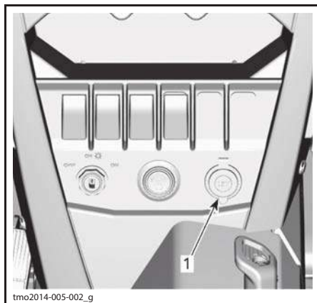
1. Электрическая розетка (12 В)
