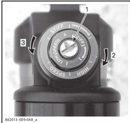
РЕГУЛИРОВКА ДЕМПФИРОВАНИЯ МЕДЛЕННОГО СЖАТИЯ (ВОСПОЛЬЗУЙТЕСЬ ОТВЕРТКОЙ)
