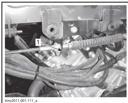
ВИД СЛЕВА – ПЕРЕДНИЙ ЦИЛИНДР 1. Свеча зажигания
