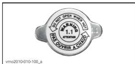
НАКЛЕЙКА 9 – ПРЕДОСТЕРЕЖЕНИЕ: НЕ ОТКРЫВАТЬ, ПОКА ДВИГАТЕЛЬ ГОРЯЧИЙ
