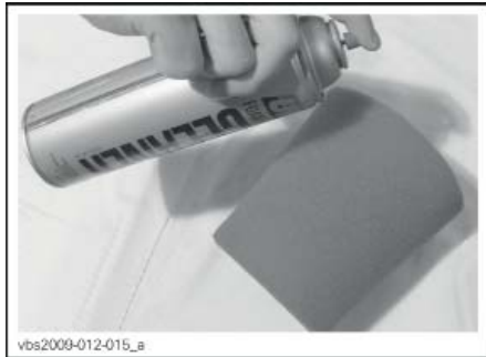
ТИПОВОЙ ВАРИАНТ – НАНЕСИТЕ ОЧИСТИТЕЛЬ НА ПОРОЛОНОВЫЙ ФИЛЬТР
