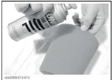
ТИПОВОЙ ВАРИАНТ – НАНЕСИТЕ МАСЛО НА ФИЛЬТРУЮЩИЙ ЭЛЕМЕНТ
