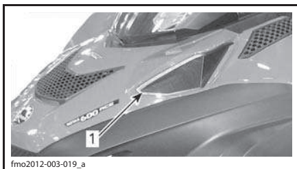
1. Фильтр предварительной очистки
