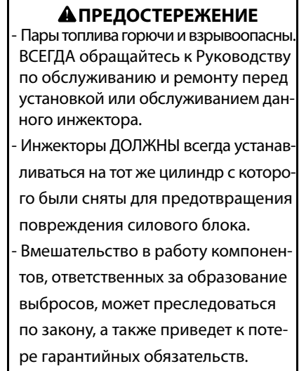
НАКЛЕЙКА 18 - НА ТОПЛИВНЫХ ФОРСУНКАХ - МОДЕЛИ E-TEC
