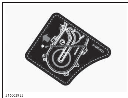
ПРОВЕРКА УРОВНЯ МАСЛА В КАРТЕРЕ ЦЕПНОЙ ПЕРЕДАЧИ - ЕВРОПЕЙСКИЕ МОДЕЛИ
