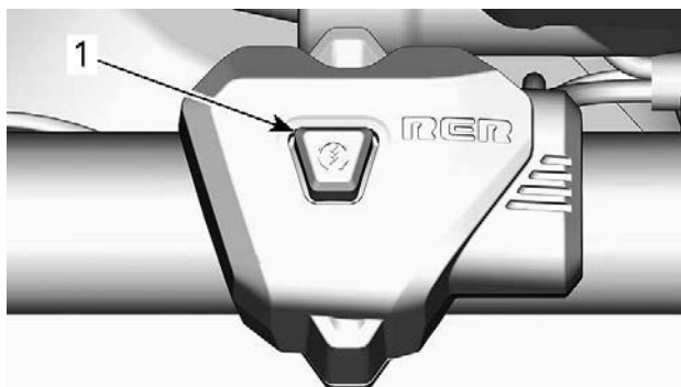
1. Кнопка запуска двигателя/включения электронного реверса
