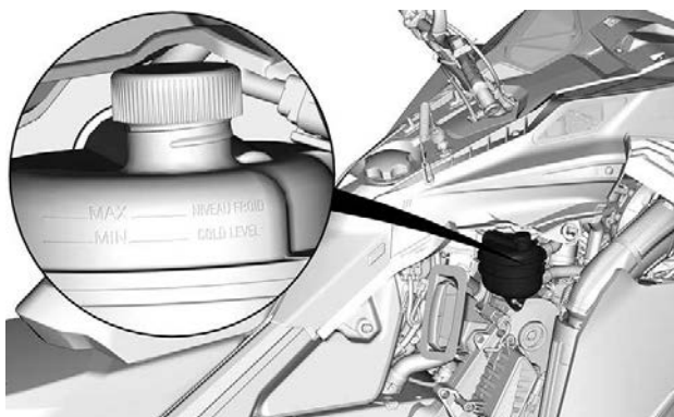
РЕЗЕРВНЫЙ БАЧОК — ЛИНИИ УРОВНЯ ХОЛОДНОЙ ЖИДКОСТИ МИН. И МАКС.
