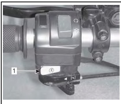
ПОЛОЖЕНИЕ РУКОЯТКИ ВОЗДУШНОЙ ЗАСЛОНКИ «FULL»
