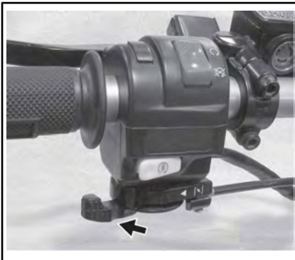
ПОЛОЖЕНИЕ РУКОЯТКИ ВОЗДУШНОЙ ЗАСЛОНКИ «FULL»
