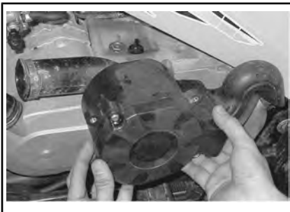
СНЯТИЕ КОРПУСА ВОЗДУШНОГО ФИЛЬТРА
