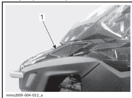
1. Фильтр предварительной очистки
