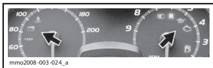
ТИПОВОЙ ВАРИАНТ – КОНТРОЛЬНЫЕ ЛАМПЫ
