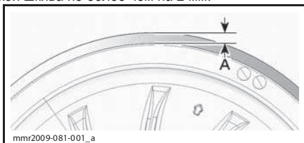
ПРЕДВАРИТЕЛЬНАЯ УСТАНОВКА А. Не более 2 мм
