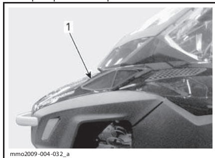
1. Фильтр предварительной очистки
