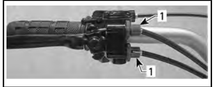
1. Регулировочные винты на рычаге тормоза
