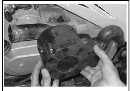
СНЯТИЕ КОРПУСА ВОЗДУШНОГО ФИЛЬТРА
