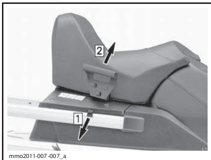
Шаг 1: Потянуть резиновый фиксатор Шаг 2: Поднять за правую часть
