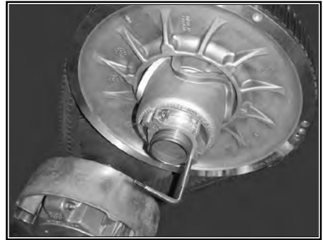
ПРИСПОСОБЛЕНИЕ ДЛЯ РАЗВЕДЕНИЯ ШКИВА В РЕГУЛИРОВОЧНОЙ МУФТЕ
