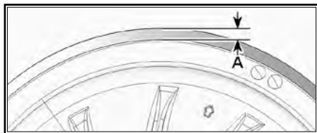
ПРЕДВАРИТЕЛЬНАЯ РЕГУЛИРОВКА А. 0–2 мм
